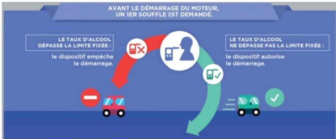
L'EAD est un dispositif qui fait l'objet d'une homologation. Il doit être mis en place dans le véhicule par un installateur agréé.
